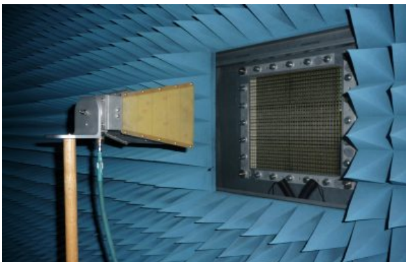
Foto: TU Dresden, IfN - Mess-Aufbau zur Charakterisierung von CF-Beton-Proben im Absorberraum des Lehrstuhles
